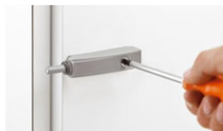
Прямой и крестообразный держатели могут регулироваться с помощью механизма шнек (от + 4,5/- 1,5 мм). Заводская настройка зазора двери составляет 2 мм.
