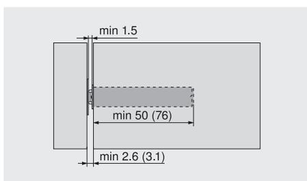
Для врезного TIP-ON с приклеивающейся пластиной мин. зазор двери составляет 2,6 мм, с привинчивающейся – 3,1 мм.
