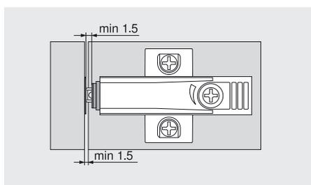
При монтаже с держателем (прямым или крестообразным) мин. зазор составляет 1,5 мм.
