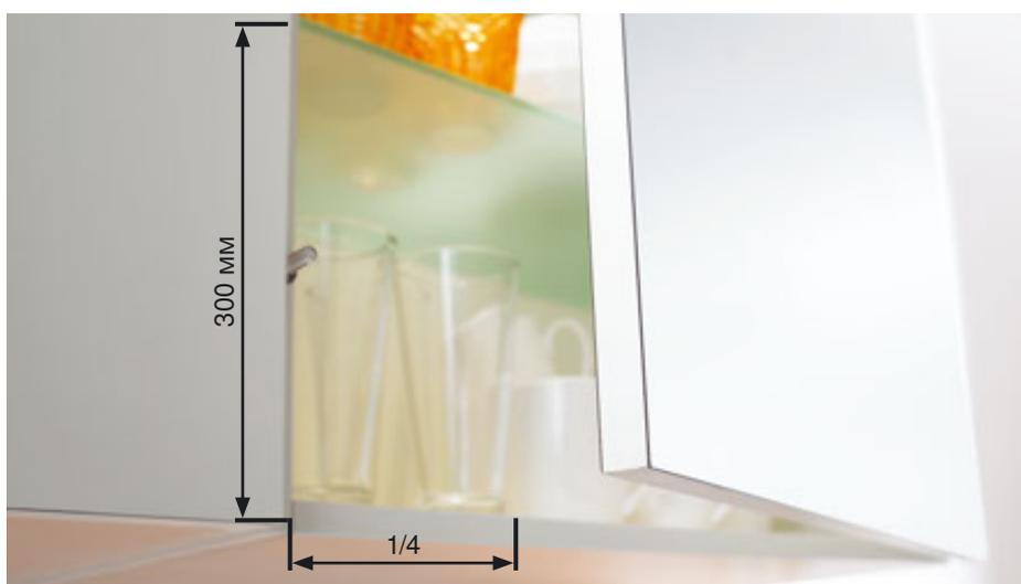
Оптимальная технология открывания обеспечивается, когда механизм TIP-ON устанавливается в той области, где обычно находится ручка. При необходимости позиция TIP-ON может отклоняться по высоте на +/- 300 мм и по ширине на 1/4 корпуса.
